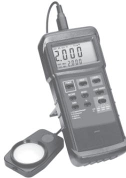
Figura 14. El luxómetro extech.
