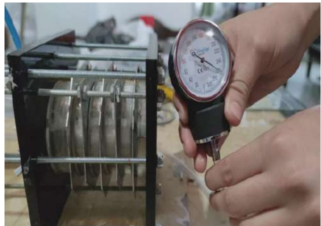
Fig. 22 Prototipo generador de H 2 . Fuente: Elaboración propia
