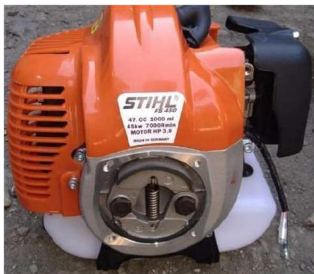
Fig. 18. Motor de combustión de dos tiempos que funcionaría con H 2 [21]
