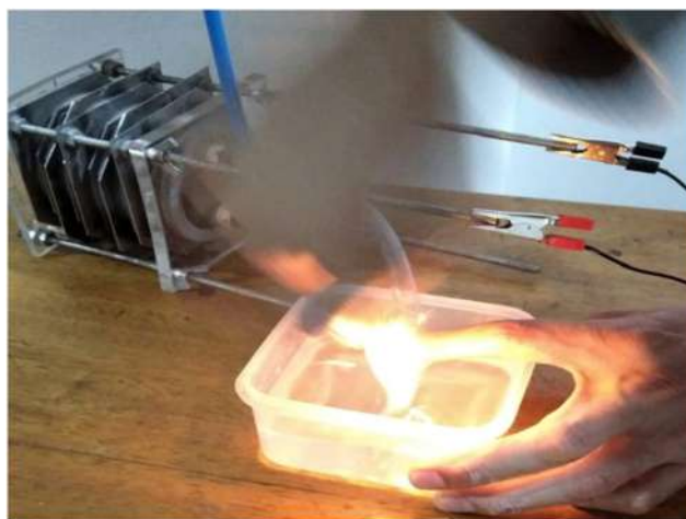
Fig. 12 Prueba de la llama en el prototipo. Fuente: Elaboración propia
