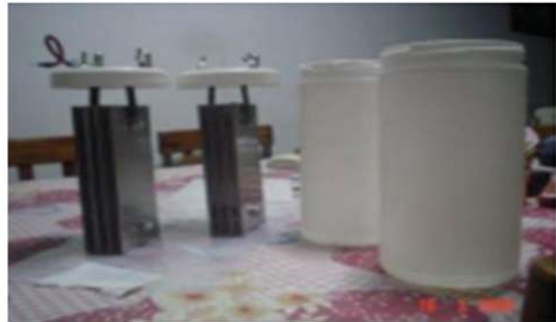
Fig. 2 Ejemplo de celda electrolizadora húmeda[13].
