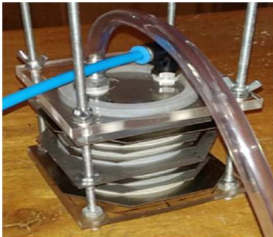
Fig. 6 Ensamble del primer prototipo generador de H 2 celda seca. Fuente: Elaboración propia
