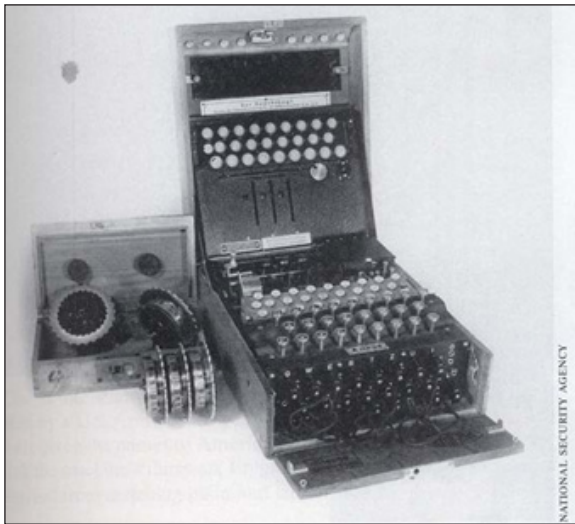
Figura 1. Máquina Enigma de cifrado rotatorio [4].
